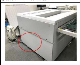
起動中に、機械の下の方(写真の赤丸付近)から、タカタと音が鳴っているか、 確認します。
