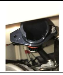
ノズルが掛かっていた筒の中も確認してください。筒の中に白い塊が有った場合は、 細い棒などで、塊を崩して除去します。
