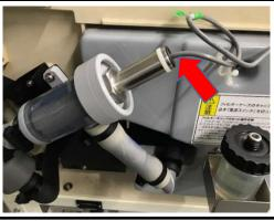
センサーケーブルの根元を見てください。 ケーブルの被覆が破れて電線が剥き出しに なっている場合は、部品交換が必要です。 コールセンターへ連絡して頂き、障害内容 は『E620-B』とお伝えください。
