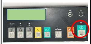
初期化動作が完了したら、運転キーを押します。
