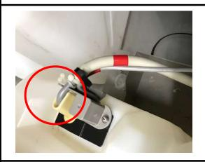
ホースの差し込まれているノズルが、きちんとセットされている事を確認します。 ノズルが浮いている場合は、修正してく ださい。
