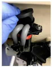
ゴムキャップを取り外します。 外したゴムキャップは紛失しないように 注意してください。
