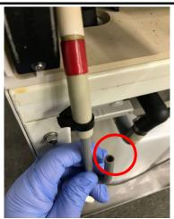
ノズルの口に異物が詰まっていたら、細い 棒などで除去します。
